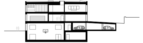
coupe transversale sur bâtiment B
